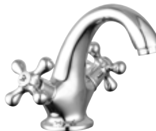
Waschtischarmatur „Elk“ keramische 1/2"-Ventiloberteile, flexible Metallanschlusschläuche, Metallgriffe, Ø 350 mm, 1/4"-Exzentergarnitur, Art.-Nr. 5400410
