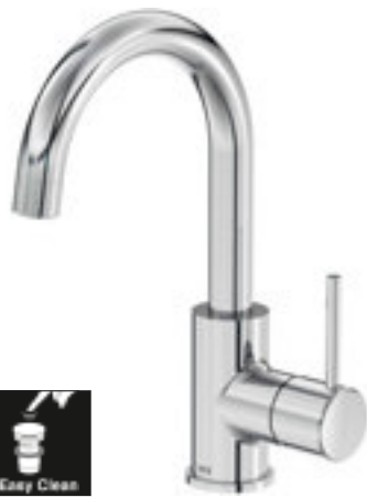
Waschtisch-Einhebelmischer „Bow 2 “ inkl. EasyFix-Befestigung, Messing, verchromt, leichtgängige 35-mm-Eco-Markenkartusche der Marke Kerox, Energieeinsparung durch Temperaturbegrenzung, gleichzeitig Verbrühschutz für Kinder, DVGW-geprüfte, flexible Anschlussschläuche, Länge 450 mm, von Neoperl, Art.-Nr. 5400429 89.99
