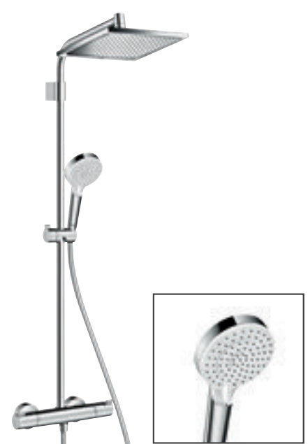
Duschsäule „Crometta E Showerpipe 240 Varia“, mit Thermostat Brausekopfgröße 240x240 mm (LxB), Kopfbrause im Winkel verstellbar, Durchflussmenge Rain-Strahl (bei 3 bar) 15 l/min, Brausearmlänge 350 mm, Thermostat Ecostat 1001 CL, Sicherheitssperre bei 40 °C, Verbraucheransteuerung durch Drehen, einstellbare Heizwasserbegrenzung, Aufputzinstallation, variable Wandstütze, Art.-Nr. 5450620 299.99
