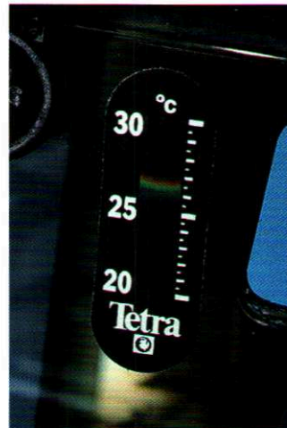
Flüssigkristallthermometer werden außen an die Scheibe geklebt.
