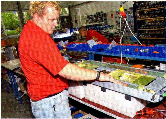
Die letzten Schritte der Lampenmontage.
