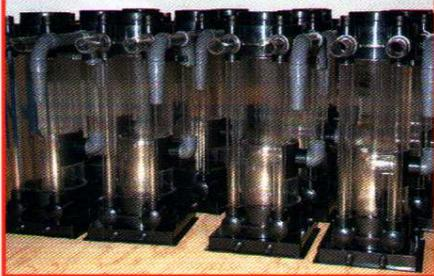
**Oben:** Ein Abschäumermodell mit Einzelteilen noch in der Vormontage.
