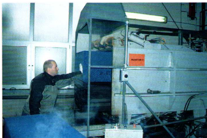
Hier wird ein zwei Meter langer Schaumstoffblock in den Reaktor geschoben, wo ein Knallgasgemisch zur Explosion gebracht wird.
