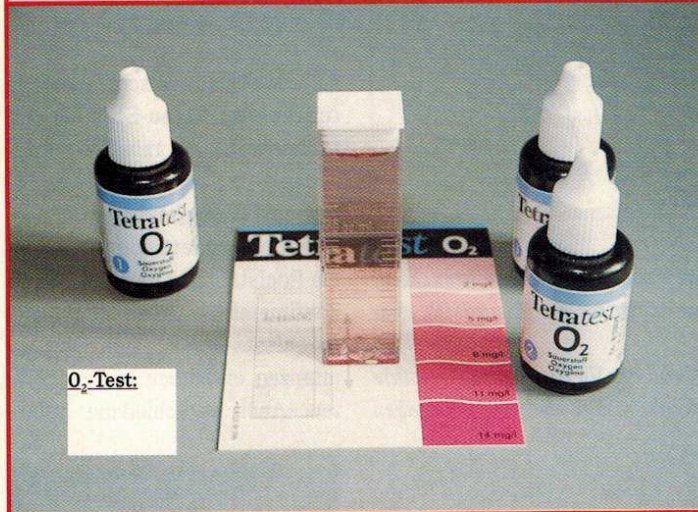
Oben: Alt bewährt und inzwischen etwas leiser: Membranpumpen zum Betreiben von Filtern und Durchlüftern. Unten: Für den Hausgebrauch ausreichend: O 2 -Tröpfchentest. Elektronische Messgeräte sind nicht nur kostspielig, sondern eine Genauigkeit, die den Aufwand rechtfertigt, erreicht man mit ihnen auch nur unter Laborbedingungen. Fotos: C. Schaefer
