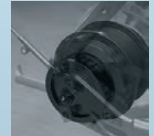
Hinterradnabenmotor (40 Nm) für direkte Kraftübertragung
