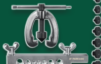
Doppel-Bördelwerkzeug-Set; zum Bördeln und Expandieren von Metallrohren; geeignet für Durchmesser von ca. Ø 5–6–8–10–12–14–16 mm; max. Wandstärke von Rohren: ca. 1 mm
