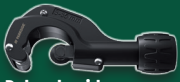
Rohrschneider; zum gratfreien Schneiden von Weichmetallrohren; für Außendurchmesser: von ca. Ø 3–35 mm; max. Wandstärke: ca. 1 mm
