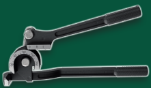
Rohrbiegezange: zum Biegen von Messing- und Kupferrohren; geeignet für Rohre von ca. Ø 6–8–10 mm; max. Wandstärke: ca. 1 mm; Biegeradius: 0–180°
