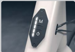
LED-Display zeigt gewählte Unterstützungsstufe und Akkustand
