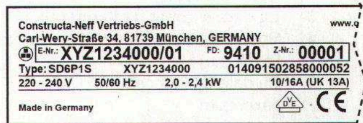
Ejemplo de placa de características con E-Nr y FD
